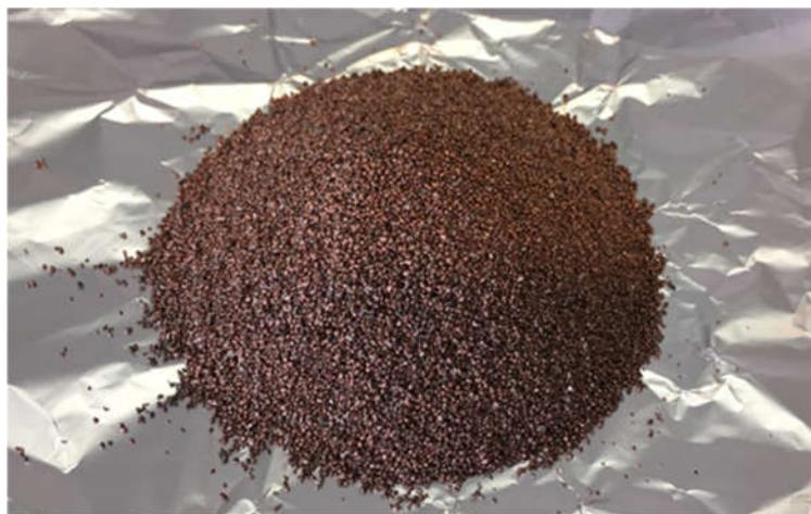
*Figura 4. Frazione metallica 1 - 0.5 mm*
