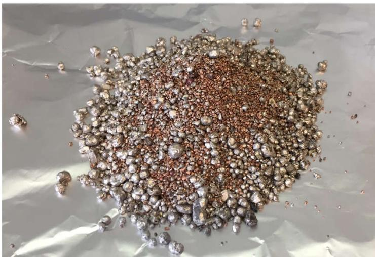
Figura 2. Frazione metallica  $\geq 2$  mm
