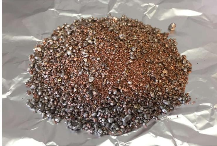
*Figura 3. Frazione metallica 2 -1 mm*
